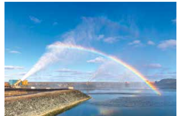
Vedenhaidutuslaitteita käytetään Meliadinen hankkeessa Nunavutissa sulan veden aikana maanpintaan varastoituneen suolaveden määrän vähentämiseksi. Näin vähennetään suolaveden mahdollista leviämistä vaikutusalueellamme.
