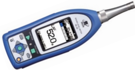
Kuva 2-2. Äänitasomittari Rion NL-52. (Lähde: www.mip.fi)
