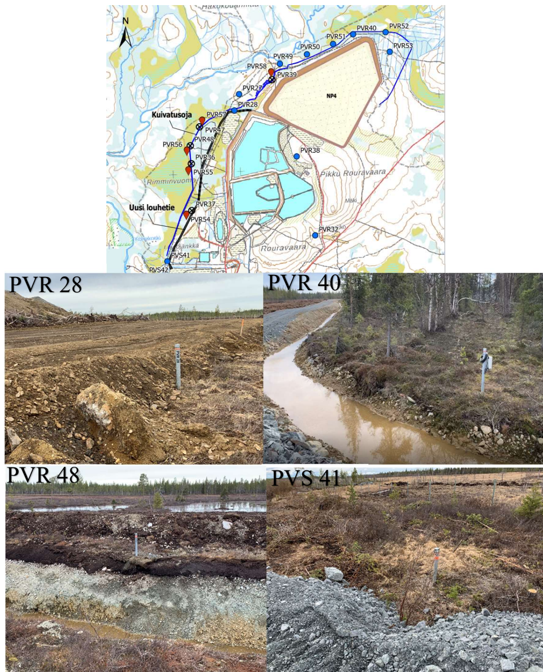
Kuva 5-3. Kuivatusojan sekä uuden louhostien sijainnit kaivosalueella yllä. Esimerkkikuvat pohjavesiputkien miljöstä, keskellä vasemmalla PVR28 ja oikealla PVR40, alavasemmalla PVR48 ja oikealla PVS41.
