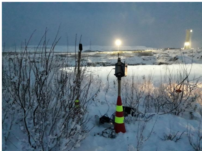
Kuva 6 AuresAir® mittauspisteessä Avoulouhos. Kuvassa myös jatkuvatoimisen meluseurannan AuresSound®- laite.
