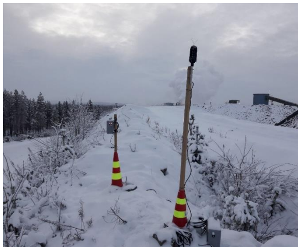
Kuva 5 AuresAir® mittauspisteessä Murska. Kuvassa myös jatkuvatoimisen meluseurannan AuresSound®- laite.
