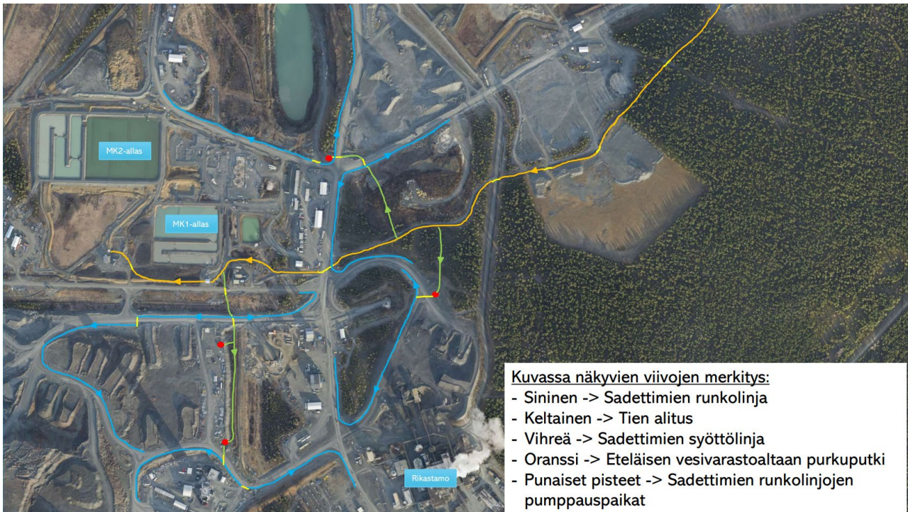
Kuva 11. Vuonna 2021 kaivosalueelle toteutettu kastelujärjestelmä
