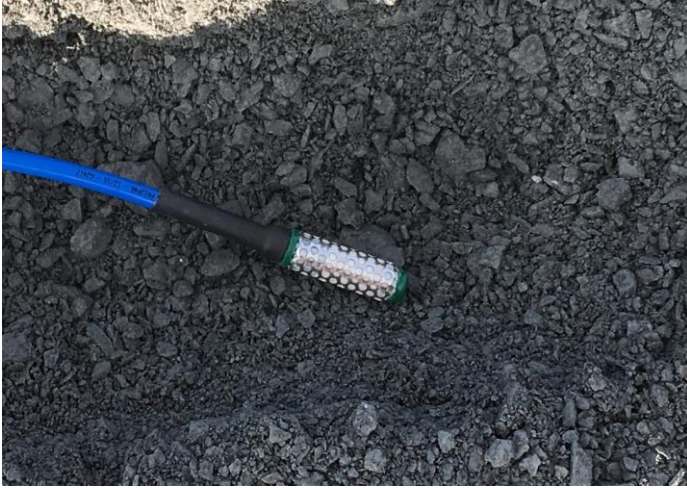
Kuva 3. Veden pidättymistä mittaava matriisipotentialianturi.
