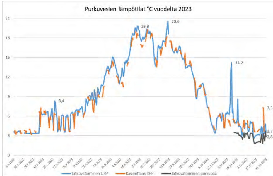
Kuva 3-10. Purkuputkeen johdetun veden lämpötila pisteeltä DPP jatkuvatoimisen (vuorokauden keskiarvo) ja käsimittaukset vuonna 2023, sekä 15.11. alkaen purkuputken loppupään jatkuvatoimiset mittaustulokset (vuorokauden keskiarvo).
