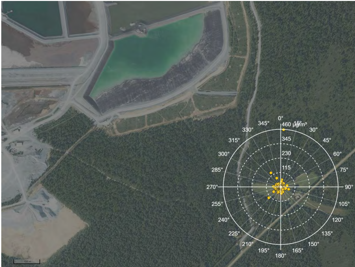
Kuva 27: Kittilän Männikön ilmanlaadun mittausasemalla mitatut hengitettävien hiukkasten yksittäiset tuntipitoisuudet ( \mu\text{g}/\text{m}^3 ) tuulensuunnittain ( 0\text{--}360^\circ ) vuonna 2023. Kuvassa eivät näy tyynellä mitatut tuntipitoisuudet. Tyyniksi on tässä tarkastelussa luokiteltu alle 0,5 m/s tuulen nopeudet. Kuvassa vasemmalla näkyy Kittilän kaivosalue. Kartta Maanmittauslaitoksen ilmapäivitys, 2022).
