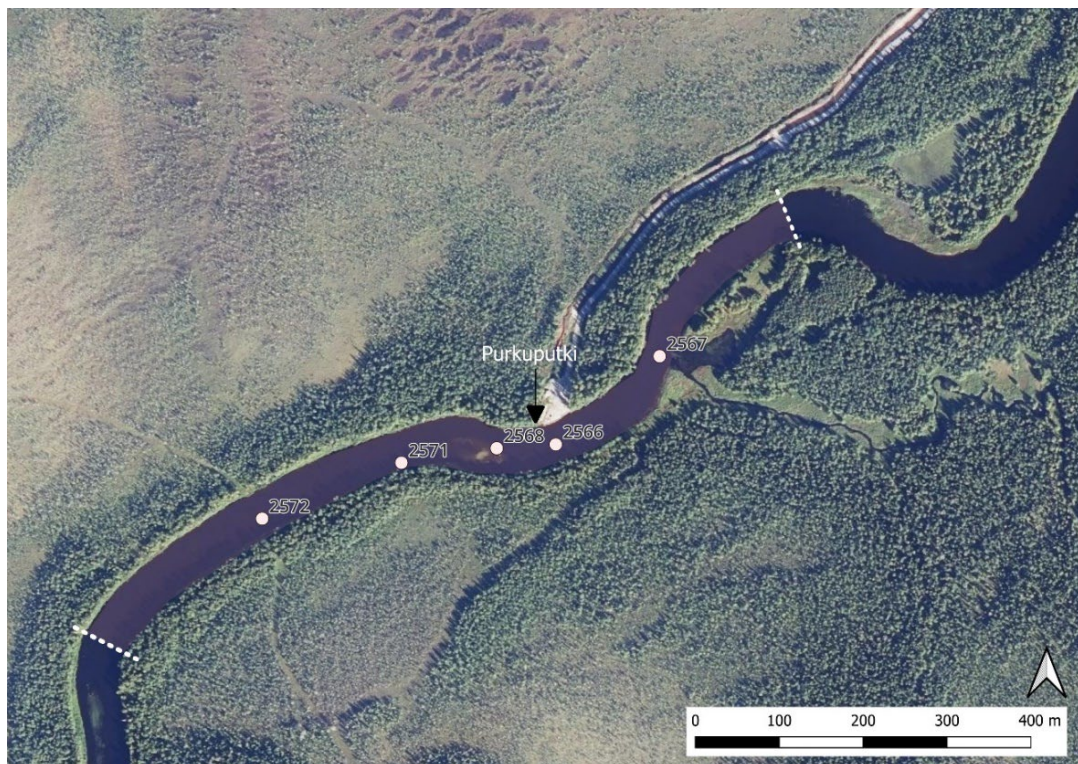
Kuva 2. Kalojen ja vedenlaadun tarkemman seurannan alue purkupuhten ympäristössä. Automaattiset tallentimet keräsivät tietoa kalojen liikkeistä (valkoiset pisteet) ja veden sähköjohtokyvyn vaihtelusta (ylin, alin ja keskimääräinen piste). (Sisältää Maanmittauslaitoksen ilmakehu-aineistoa).
